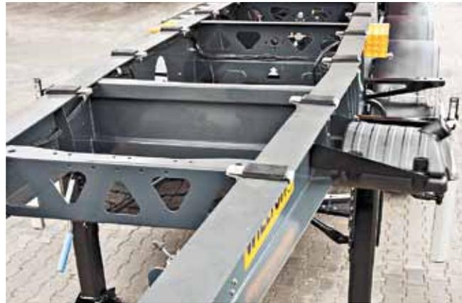
Рама оригинальной конструкции: сужена в передней части и, для уменьшения веса, – с перфорированными балками
