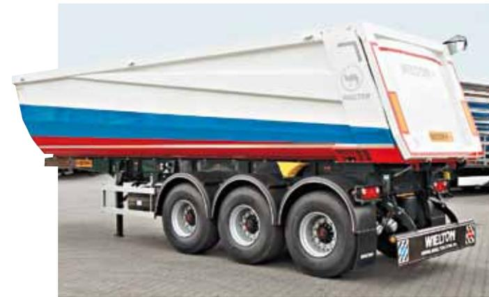
Вдоль боковых стенок кузова предусмотрены отштамповки, придающие ему дополнительную жесткость
