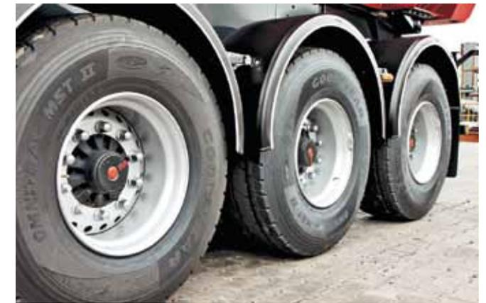
Осевые агрегаты полуприцепа рассчитаны на нагрузку 11 тонн каждый. Хотя есть варианты и на 9 тонн
