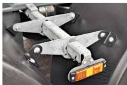
Проверенное решение – кронштейны крепления крыльев и контурных огней
