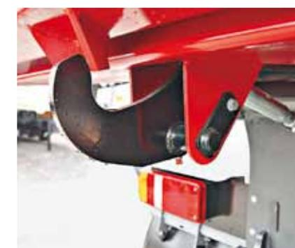
Автоматические запоры заднего борта должны быть отрегулированы
