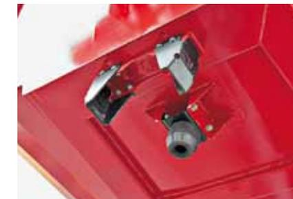
Таким способом кузов фиксируется в транспортном положении
