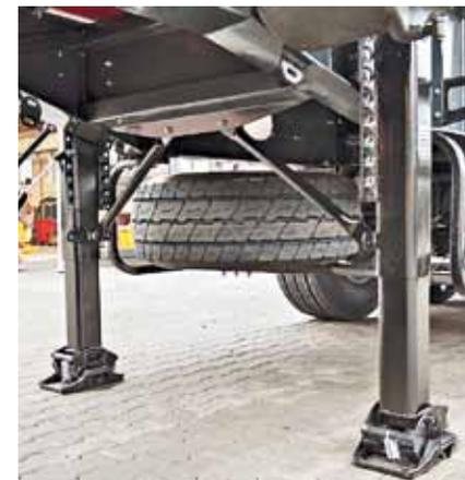
Опорное устройство произвела известная эксплуатационникам компания Jost
