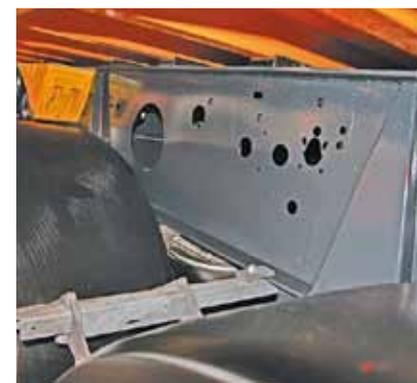
Рамы самосвалов изготавливают из высокопрочной стали Domex S700
