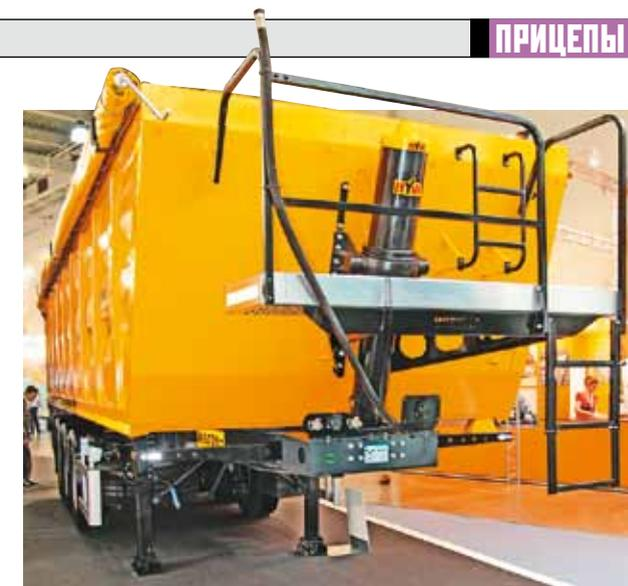
Для ускорения процесса разгрузки передняя стенка выполнена наклонной. Поднимает кузов гидравлика Hуva
