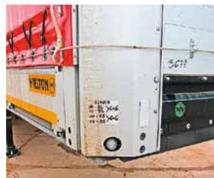
Для удобства погрузки/разгрузки кузов (на версии прицепа с индексом M2) получил возможность растентовки еще и от передней стенки
