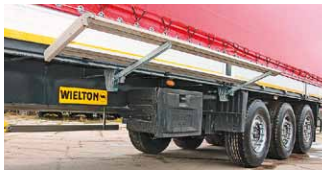
Боковой противоподкатный брус стал удобнее в использовании (на фото слева) – для его подъема нужно гораздо меньше действий. Кроме того, на смену алюминиевому профилю пришла сталь и пластик
