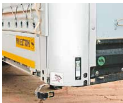
Для удобства погрузки/разгрузки кузов (на версии прицепа с индексом M2) получил возможность растентовки еще и от передней стенки
