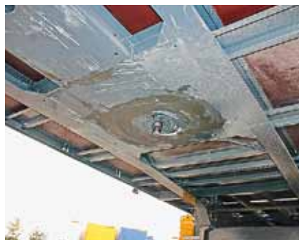
Переднюю часть рамы, в том числе крепление опорной плиты, на новой версии усилили, приварив дополнительный стальной профиль (на фото слева)
