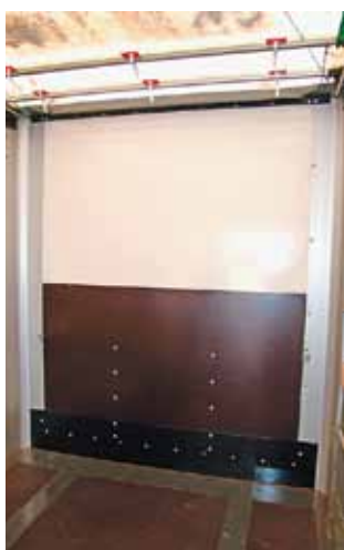
Переднюю стенку (фото слева) усилили плитой повышенной прочности, соответствующей норме VDI – DIN EN 12642XL
