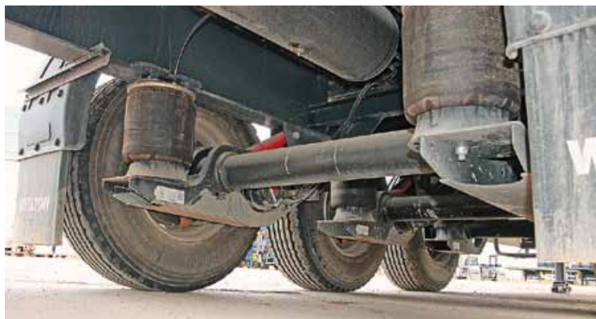
Ходовая часть полуприцепа – осевой агрегат SAF (как в данном случае) либо производства не менее известной компании BPW
