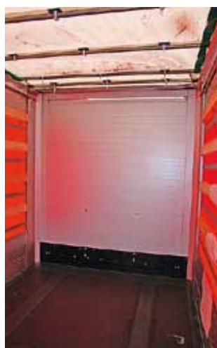
Переднюю стенку (фото слева) усилили плитой повышенной прочности, соответствующей норме VDI – DIN EN 12642XL
