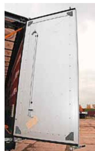
Задние ворота со вставкой из пластикового полотна (на фото слева). Предыдущий вариант только из алюминия
