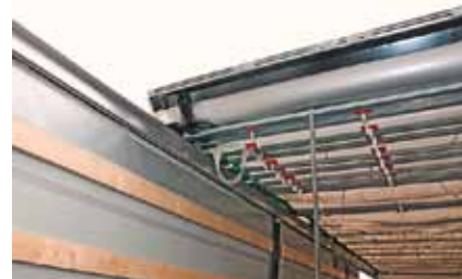
Для верхней загрузки/выгрузки прицепа имеется сдвижная крыша
