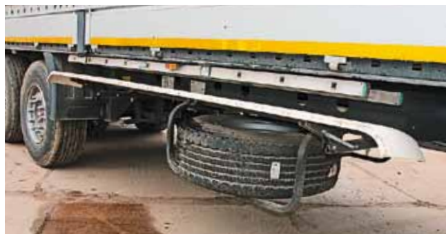
Боковой противоподкатный брус стал удобнее в использовании (на фото слева) – для его подъема нужно гораздо меньше действий. Кроме того, на смену алюминиевому профилю пришла сталь и пластик
