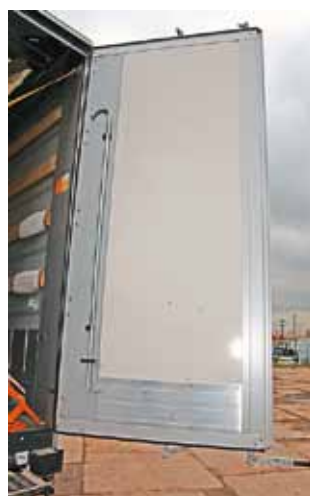
Задние ворота со вставкой из пластикового полотна (на фото слева). Предыдущий вариант только из алюминия
