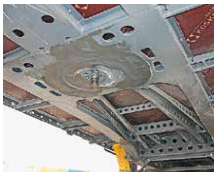
Переднюю часть рамы, в том числе крепление опорной плиты, на новой версии усилили, приварив дополнительный стальной профиль (на фото слева)
