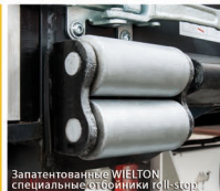
Запатентованные WIELTON специальные отбойники roll-stop
