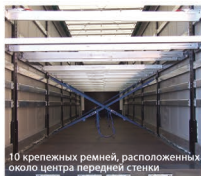
Уровень второго пола с максимальной загрузкой до 900 кг на 22 перекладины
