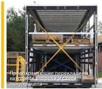
Перфорированные боковые перекладки допускают гибкое местоположение перекладин для поддержки груза
