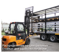
Устройство центральных стоек допускает погрузку товаров различных высот
