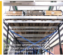
Уровень второго пола с максимальной загрузкой до 900 кг на 22 перекладины
