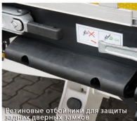
Резиновые отбойники для защиты задних дверных замков
